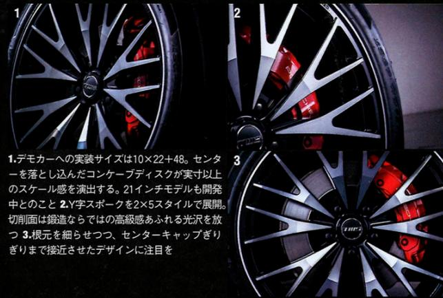
1.デモカーへの実装サイズは10×22+48。センターを落とし込んだコンケーブディスクが実寸以上のスケール感を演出する。21インチモデルも開発中とのこと 2.Y字スポークを2×5スタイルで展開。切削面は鍛造ならではの高級感あふれる光沢を放つ 3.根元を細らせつつ、センターキャップぎりぎりまで接近させたデザインに注目を
