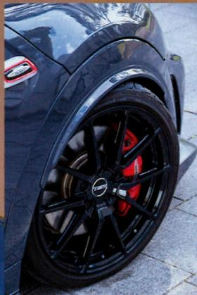
1.オーバーフェンダーにタイトなマッチングを見せるエクスリート115F。フィンのように見えるマルチスポークの美しさが、スパルタンさのなかに華やかさをプラスする 2.もちろんメイドインジャパンの刻印あり。リム端を一段落としてアクセントにしている 3.ボルトホールを巧みにV字スポークへと取り込むことで、センターパッケージを小さく、スポークをより長く見せることに成功している 4.強力な走りのJCWゆえにブレーキは大型なものが備わっているが、キャリバーのクリアランスは問題ナシ。撮影車では+5mmのスペーサーを追加することでツラを合わせている
