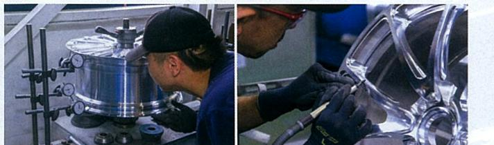
↑右上はバリ取り、左上は振れ検査、右下は組み付けと、多くの工程に職人の手が介在するのもTWSの特徴。工業製品というよりも工芸品と呼ぶ方が相応しいように思える
