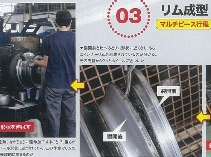
▲リムを熱しながら延伸加工することで、誰もが知るホイール形状に近づいていく。この作業でリムの強度が飛躍的に高まるのだ
