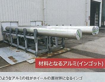
電柱のようなアルミの柱がホイールの原材料となるインゴットだ。これをサイズに合わせて必要な分だけ切り出して使用する。円柱の塊が1回のプレスで円盤型に変形する。
